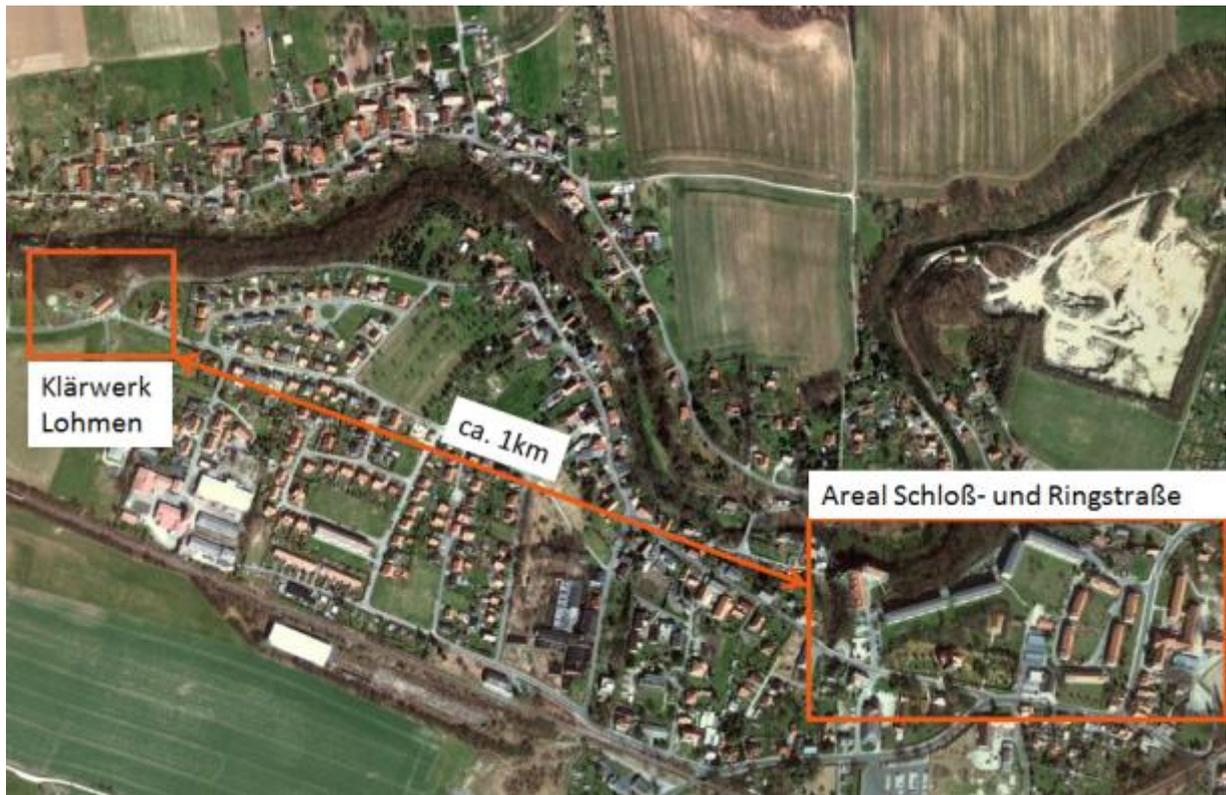
Abb. 18: Anbindung Klärwerk Lohmen an Quartiersversorgung über ein Nahwärmenetz [10]
