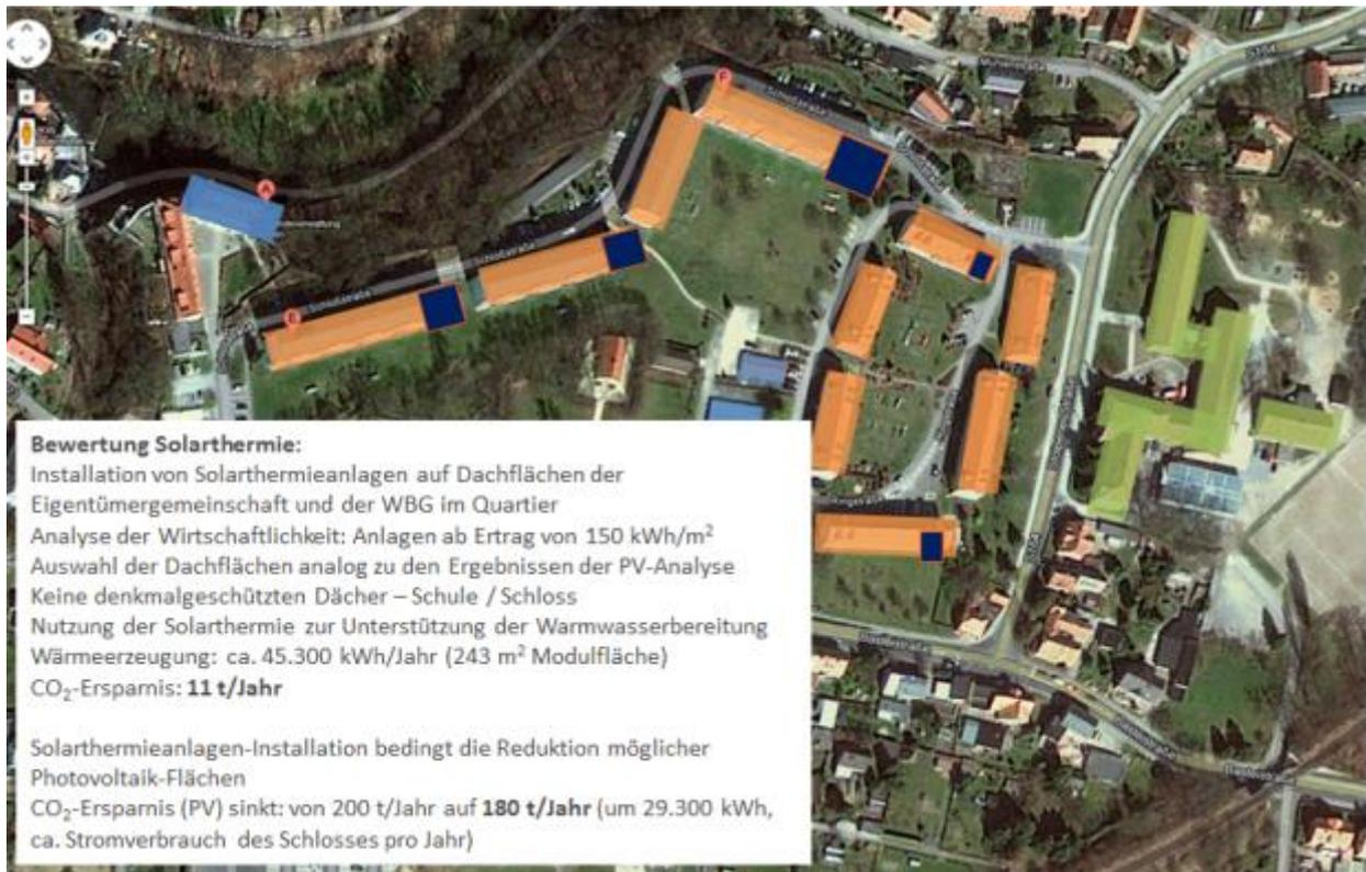
Abb. 16: Einsatz von Solarthermieanlagen zur Warmwasserbereitung in Quartier [10]
