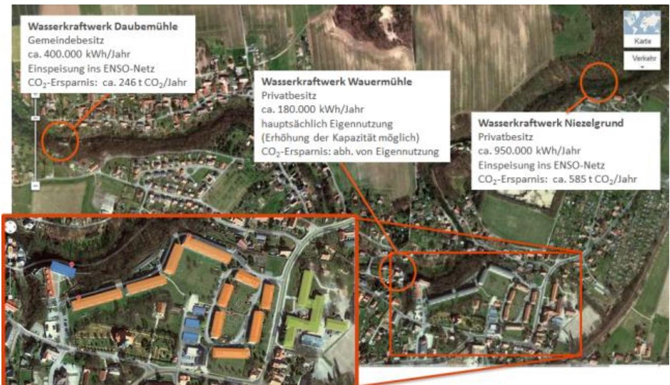
Abb. 12: Wasserkraftwerke im Einzugsbereich der Gemeinde Lohmen [10]
