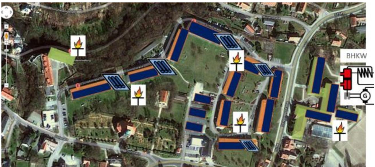
Abb. 21: Systemvariante 3 mit lokalen Nahwärmenetzen, Photovoltaik, Solarthermie und zentralem BHKW im Schulgebäude [10]
