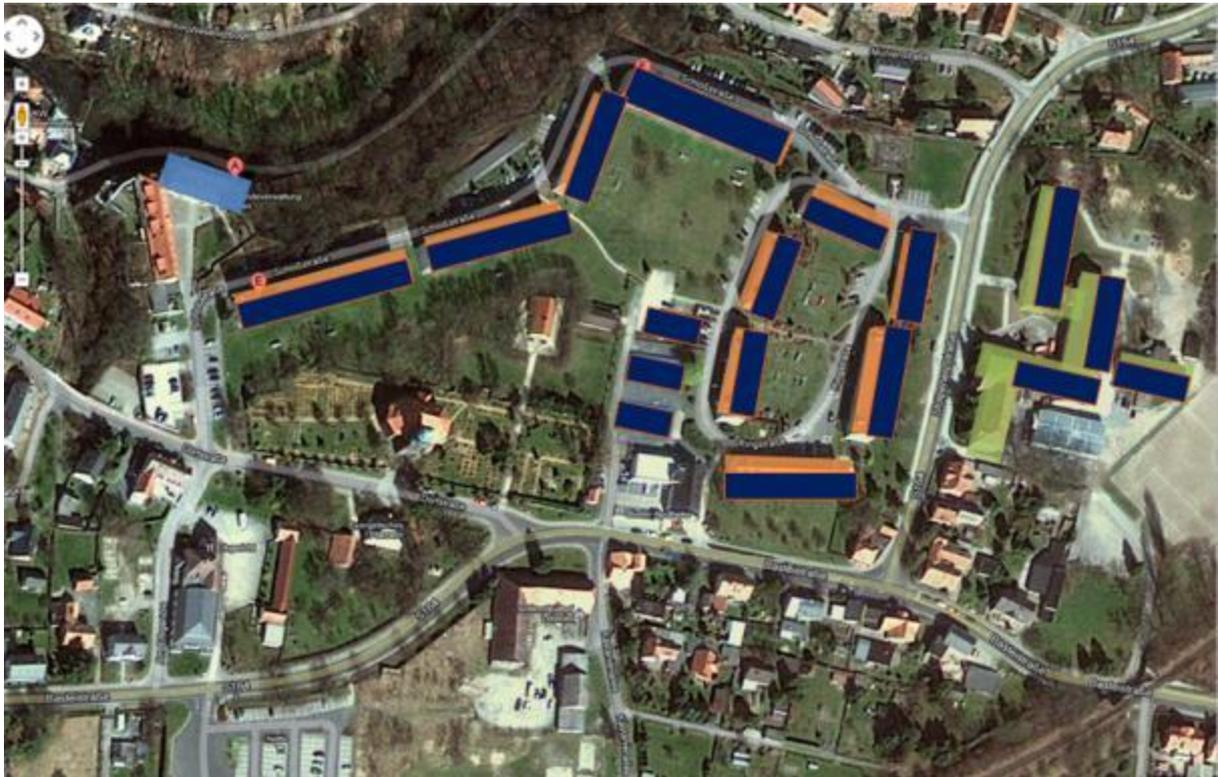
Abb. 10: Standorte für geeignete Photovoltaik-Dachflächen im Quartier [10]
